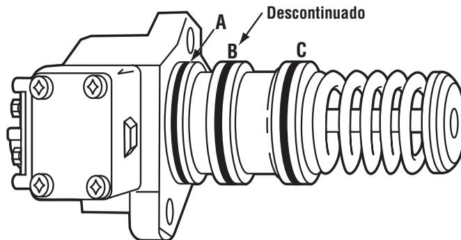
**Nota:** Un cambio en la producción a sido el descontinuar el uso del ANILLO-O CENTRAL (posición B) en las bombas de inyección de E-Tech. También ha sido retirado de nuestro kit EKT-8561. Cuando monte los anillos-O en la bomba de inyección, use el más grueso para la canal inferior (posición C), y el otro anillo en la superior (posición A). Asegúrese de lubricar con aceite de motor para facilitar la instalación.
